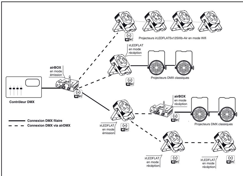
Note : L'airBOX est le boîtier utilisant la même technologie DMX sans fil que le boîtier projecteur irLEDFLAT-Air.
